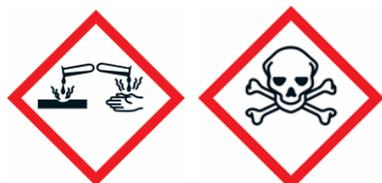
L'acido fluoridrico (CAS n° 7664-39-3) è un gas incolore, tossico, corrosivo e non infiammabile, dall'odore pungente e particolarmente irritante. È molto solubile in acqua ed è in grado di intaccare il vetro; Sebbene la corrosione dovuta all'HF sia lenta in confronto ad altri acidi minerali, le piccole dimensioni
